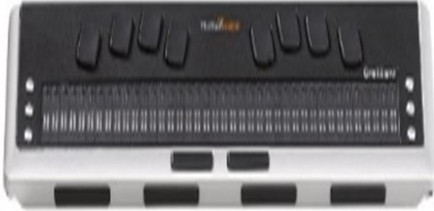
لوحة مفاتيح لقراءة النصوص بطريقة برايل **Braille Display/Reader**: لوحة دقيقة وعملية وسريعة الاستجابة للقراءة بطريقة برايل، وتحتوي على مفاتيح للأوامر على كل جانب من الشاشة.
